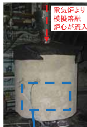
↓上図の耐熱材試験片を、試験後に上図と同様の角度で見た図
