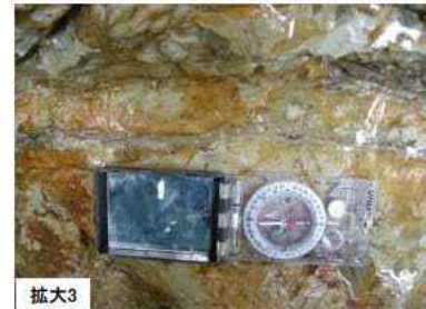
拡大3 拡大4 ● 泥岩中の断層面の連続性はやや不明瞭で平面性は低い。また幅約5mmの砂礫岩を挟在しているが、粘土状破碎部を伴わない。 ● 砂礫岩は、周囲の砂岩層と同様の固結の程度である。
