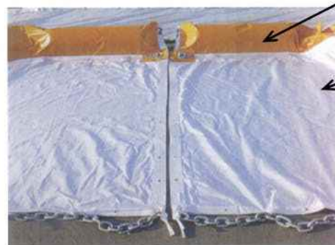
汚濁防止膜 展開状態(例)
