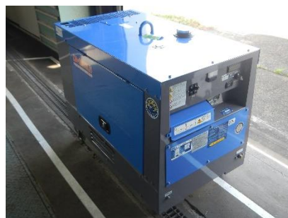
可搬型発電機
