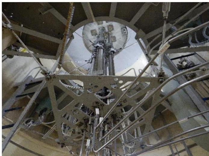
制御棒駆動装置写真(下方より撮影)
