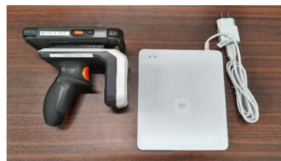
試作したシステムに用いた 模擬スマート工場のIoTツール （RFIDリーダーライター）
