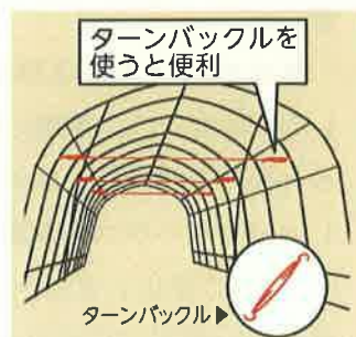
図7 ワイヤーを使用した補強
